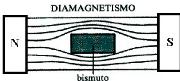
Fig 4 Desvio das linhas de força de um campo magnético na presença de um corpo diamagnético ( \mu_r<1 ).
