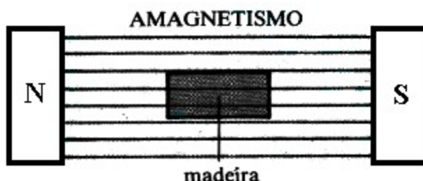
Fig. 3 Linhas de força de um campo magnético atravessando um material a-magnético. O campo não mostra deformação ( \mu_r=1 ).
