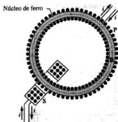
Fig. 5 Campo magnético externo ( H_0 ) aplicado a uma amostra ferromagnética em forma de anel.
